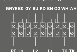
Схема 5 (400 В, 3 ф, 50 Гц.)
